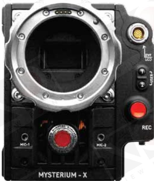
拆掉鏡頭接圈的螺絲
