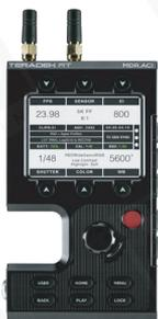
3頻集成接收器結合Teradek RT可無線控製鏡頭焦點、光圈及變焦。
